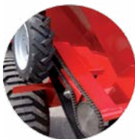
Caduta del concime proporzionale alla velocità di avanzamento Débit proportionnel à l'avancement de la machine. Speed-proportionate fertilizer drop system Geschwindigkeit-anteiliges Düngersfallsystem
